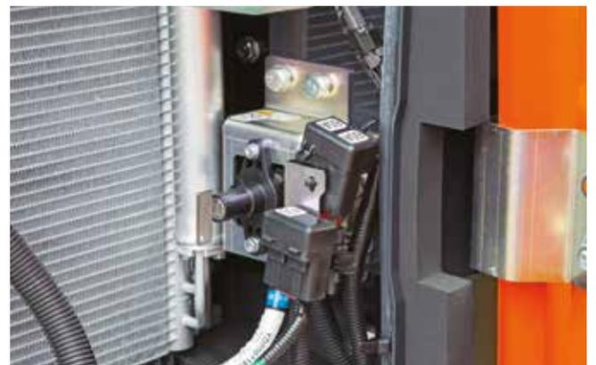
Grâce à l'interrupteur de déconnexion des batteries, les entretiens peuvent être effectués en toute sécurité.
