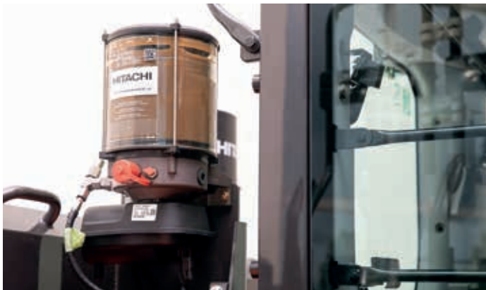
Le système de graissage automatique en option vous fait gagner du temps.
