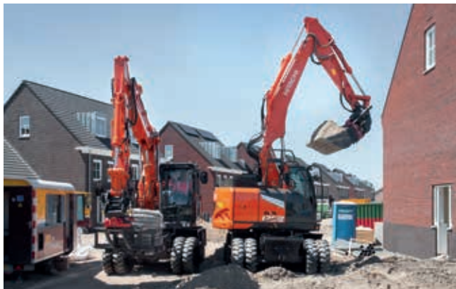
Le modèle ZX135W-7 tourne dans un rayon 3,5 mètres (1 740 mm vers l'arrière et 1 750 mm vers l'avant).
