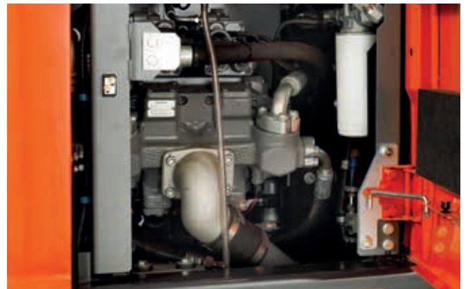
Le système hydraulique HIOS V (ZX150W-7 et ZX155W-7) une économie de carburant jusqu'à 5 %.
