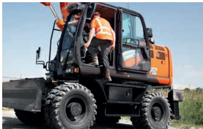
La première marche basse permet de sécuriser et de faciliter l'entrée dans la cabine.
